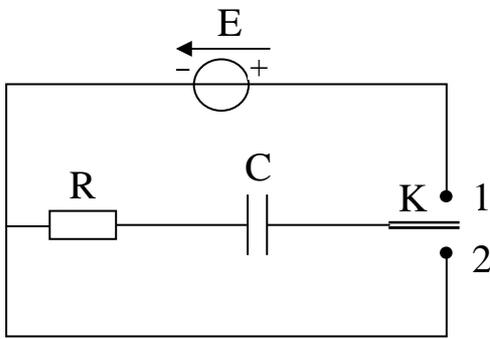
بواسطة مولد توتر ثابت قوته المحركة الكهربائية  $E$  ، ناقل أومي مقاومته  $R$  ، مكثفة غير مشحونة سعنتها  $C$  ، قاطعة  $K$  نحقق المبين في الشكل المقابل ، نغلق القاطعة و عندما تشحن المكثفة كليا ، نغير البادلة من الوضع (1) إلى الوضع (2) .
