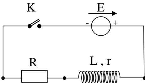
بواسطة مولد توتر ثابت قوته المحركة الكهربائية  $E$  ، ناقل أومي مقاومته  $R$  ، وشيعة ذاتيتها  $L$  و مقاومتها الداخلية  $r$  (غير مهمة) ، قاطعة  $K$  نحقق المبين في الشكل المقابل ثم نغلق القاطعة :
