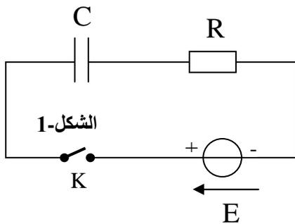
نربط على التسلسل العناصر الكهربائية التالية : ناقل أومي مقاومته  $R = 100 \Omega$  ، مكثفة غير مشحونة سعتها  $C = 4 \cdot 10^{-4} F$  ، مولد ذو توتر كهربائي ثابت  $E = 12 V$  ، قاطعة (K) (الشكل-1) .
